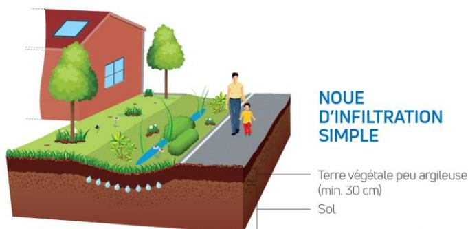
Une combinaison est possible avec une tranchée d'infiltration, dans les cas d'un terrain ayant une faible perméabilité.
