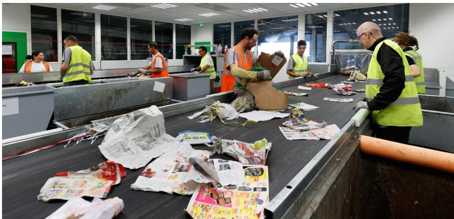
Table de tri manuel : des opérateurs retirent, non sans risques, les indésirables et autres "erreurs" de tri.
