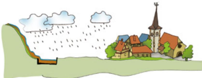
Placés en amont, les bassins de rétention permettent de protéger les habitations des inondations et des coulées de boues.
